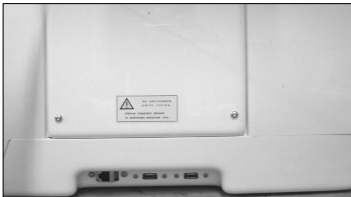
Fig. 6 – Connettori USB ed Ethernet (sinistra) / interruttore e presa di alimentazione (destra)
