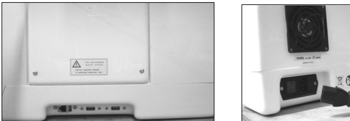
Fig. 6 – USB y conectores Ethernet (izquierda)/entrada de electricidad e interruptor principal (derecha)
