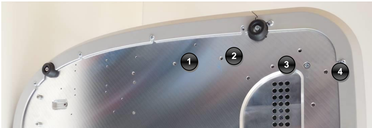
Fig. 14 – Fori per il montaggio dei supporti di tablet e joystick sulla base dello strumento
