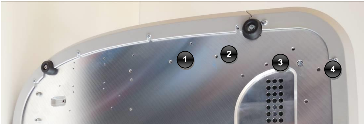
Fig. 14 – Partie inférieure du dispositif avec les orifices destinés aux supports de la tablette et du joystick
