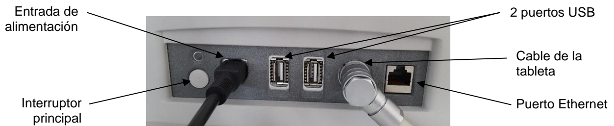
Fig. 6 – Detalle del lado de los conectores
