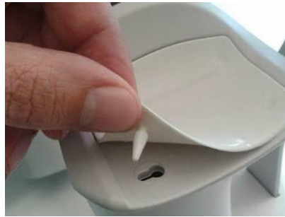
Abb. 90 – Entfernen des Silikonpads der Kinnstütze
