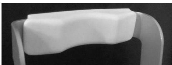
Fig. 14 – Apoyo para la frente montado en el soporte de metal
