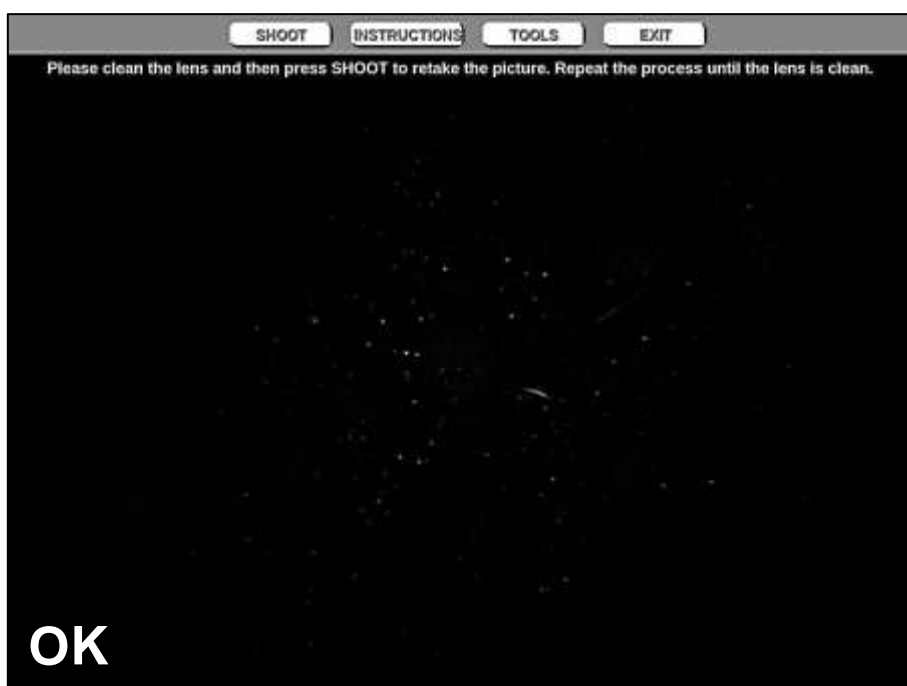
Figura 69 – Exemplo de uma lente frontal limpa
