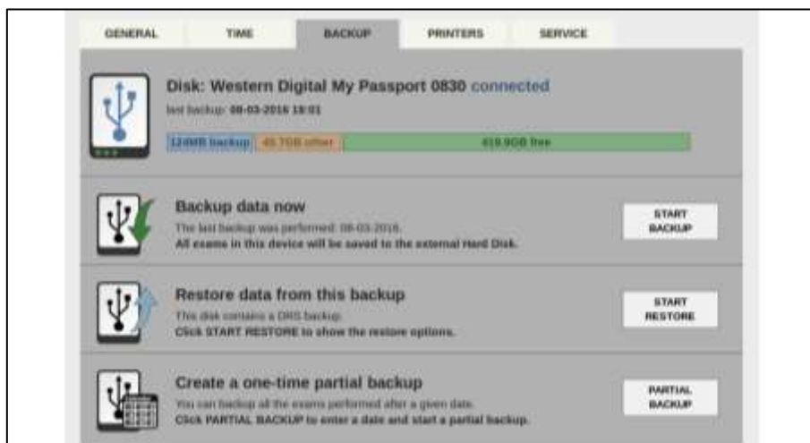
Figura 38 – Scheda Settings > System > BACKUP nelle impostazioni del DRS quando si collega il supporto USB usato per il precedente backup
