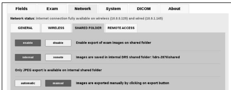
Figure 52 Onglet Network >> SHARED FOLDER sous Settings, lorsque le mode MANUAL est sélectionné
