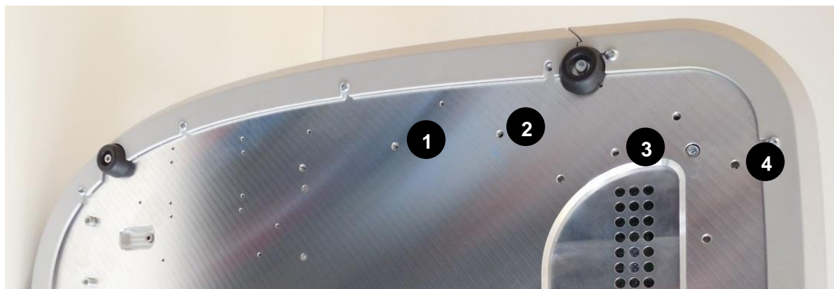
Fig. 12 – Parte inferior do instrumento com os orifícios para o suporte do tablet
