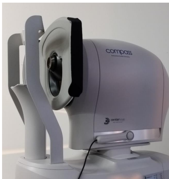
Fig. 13 - Capuz magnético montado no COMPASS
