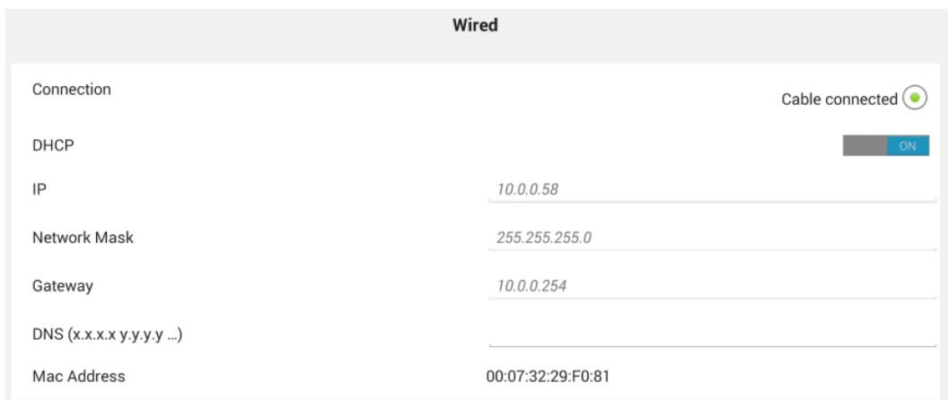
Fig. 74 – Configurator – Tela configuração rede específica (neste caso: configuração de rede por cabo)
