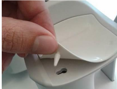
Fig. 83 – Rimozione del poggiamiento in silicone
