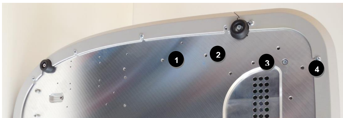
Fig. 12 – Parte inferior del instrumento con orificios para la fijación del apoyo de la tableta
